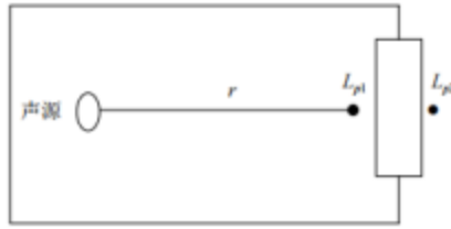
图 4-2 室内声源等效为室外声源图例
