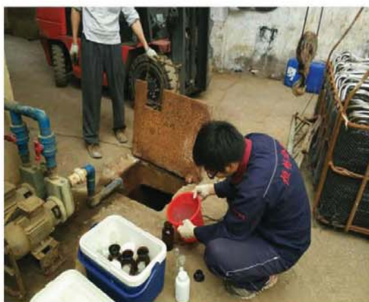
图19: 生产废水集水池（处理前）
