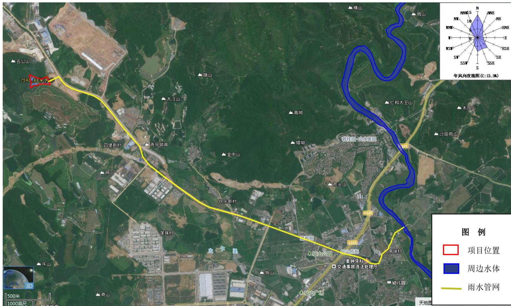
图4.2-1 本项目雨水管网汇入址山河管网走向图
